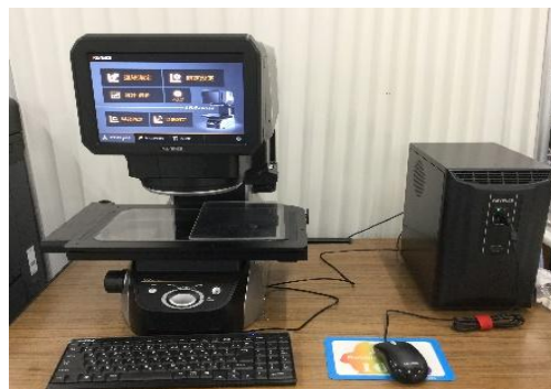
高精度 画像寸法測定器 ( \pm 0.1\mu\text{m} ) (200mm × 300mm)
