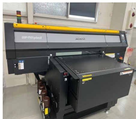
UJF-7151 plus II 印刷有効寸法 巾710mm × 送り510mm
