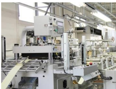
5t自動打抜き機(UDP) (200mm × 200mm)
