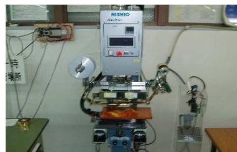
アップダウン箔押し機 (190mm × 100mm)
