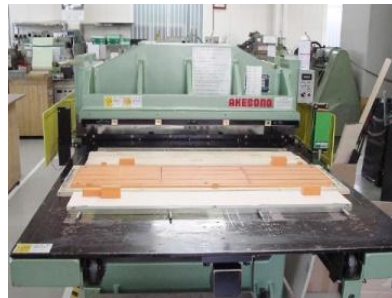
110t打抜き機 (980mm × 1100mm)
