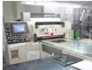
NC順送打抜き機 (580mm × 380mm)
