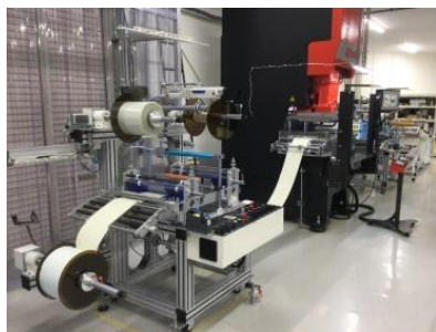
80t自動打抜き機 (450mm × 750mm)
