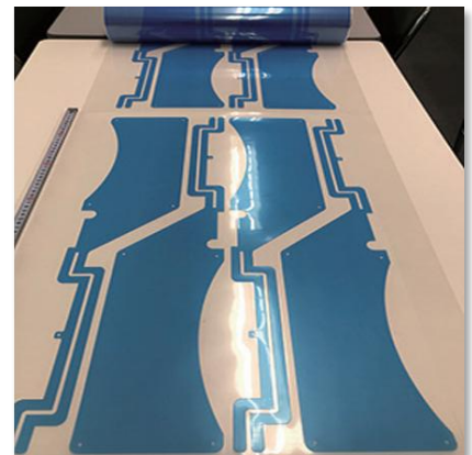
No.18 大型保護フィルム (製品サイズ400mm×750mm) ロールtoロールで完全自動生産可能
