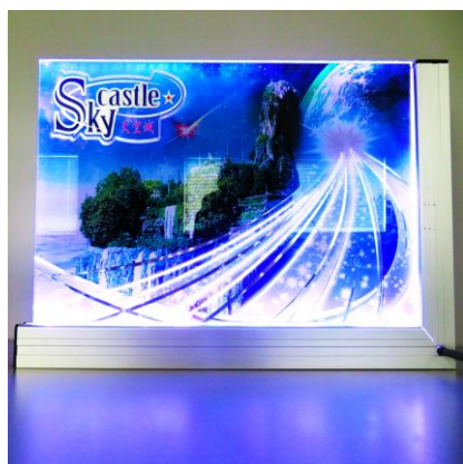
No.25 アクリルLEDスタンド(5t) NC切削、印刷シート抜き、貼り合わせ サンドエッジからのLEDで光ります
