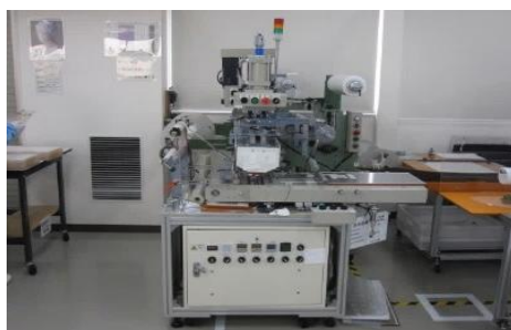
ローラー箔押し機 (最大巾280mm)
