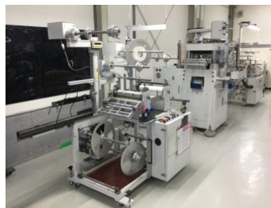
10t自動打抜き機(UDP) (300mm × 250mm)
